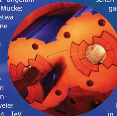
Widerstand leitet und dadurch viel stärkere Magnetfelder erzeugen kann als normalleitende Elektromagnete. Die LHC-Magnete bestehen aus einer Niob-Titan-Legierung und werden bei einer Temperatur von nur 1,9 K (-271°C) betrieben. Die Stärke von Magnetfeldern wird in Einheiten von „Tesla“ angegeben. Im LHC herrschen Magnetfelder von ungefähr 8 Tesla, wohingegen normalleitende, „warme“ Magnete nur Felder von maximal 2 Tesla erzeugen können.
