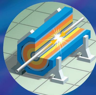
Bei voller Energie besitzt jeder Strahl ungefähr soviel Energie wie ein Auto bei 1600 km/h. Die in den Ablenkmagneten gespeicherte Energie wäre genug, um 50 Tonnen Kupfer zu schmelzen.
